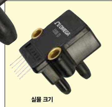
PXSCX 시리즈 제품은 PC 보드에 장착 가능한 소형 패키지 내의 집적 회로 센서 소자와 레이저 가공 전기 회로망을 특징으로 가지고 있습니다. PXSCX 센서는 내부적으로 캘리브레이션과 온도 보상이 이루어지고 0 에서 70°C (32 에서 158°F)의 넓은 온도 범위에 걸쳐서 안정적이고 정확한 출력을 제공합니다. 본 제품은 공기나 다양한 산업용 또는 실험실 용도로 공통적으로 사용되는 건조한 비-부식성, 비-이온성 가스에 적용될 수 있도록 설계되었습니다. 또한 100 μsec 의 빠른 응답시간을 가지고 있어 공압 제어 용도로 매우 이상적입니다.
