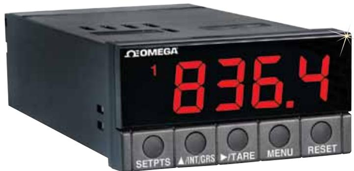
DP25B-S 모델은 전압, 전류 또는 브릿지형 트랜스듀서와 함께 사용되는 저가의 디지털 패널 미터기입니다. 브릿지형 센서에 대해, DP25B-S 모델은 여기 전압의 변화를 교정하기 위해 비례척도식으로 입력값을 사용합니다. 기본 특징으로는 전방 패널 테어 버튼과 최대값 홀드 기능을 가지고 있습니다. 선택 사양으로는 이중 5 A 알람 릴레이와 0 ~ 10V 또는 4 ~ 20 mA 으로 맞춤 가능한 아날로그 출력 기능을 포함합니다.
